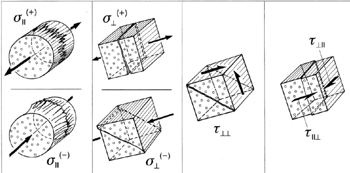
Versagensmechanismen (Quelle: A. Puck, Festigkeitsanalyse von Faser-Matrix-Laminaten, 1996)
