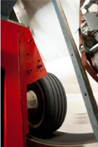
Reifen-Fahrbahn-Geräusch ist heute die Hauptkomponente des Verkehrslärms und muss bis 2020 von 6 Dezibels reduziert werden. Am Institut für Fahrzeugsystemtechnik werden zu diesem Thema unter anderem akustische Messungen durchgeführt. Um das Reifen-Fahrbahn Geräusch von dem Gesamtfahrzeug-Geräusch zu isolieren muss dafür eine Radführung für den Akustikrollenprüfstand konstruiert werden.
