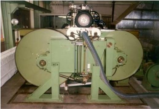
Das Institut für Fahrzeugsystemtechnik betreibt seit Jahren einen weltweit etablierten Außentrommel-Flachbahn-Prüfstand zur Erfassung des Rollwiderstandsverhaltens von PKW-Reifen.
