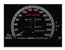
Basierend auf dem Mercedes-Benz Reifendruckkontrollsystem (RDKS) soll ein Warnkriterium überprüft werden, welches eine mögliche Reifenüberlastung erkennen soll.
