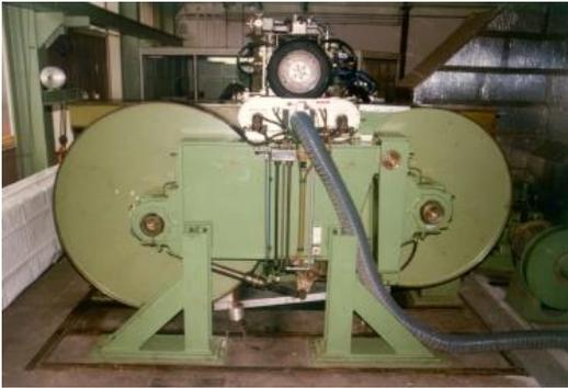
Im Rahmen eines aktuellen Forschungsprojektes, das sich mit dem Rollwiderstand von PKW-Reifen befasst, soll das Erwärmungsverhalten eines Reifens während einer Rollwiderstandsmessung auf dem Außentrommel-Flachbahn-Prüfstand untersucht werden.
