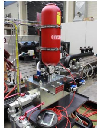
Ein zentrales Element der Arbeit ist die zuverlässige Regelung von Öl-Temperatur und -druck, sodass beide Größen gezielt auf vorgegebene Werte eingestellt werden können. Der Durchfluss, der durch den Riss fließt, ist zu messen. Die Abschlussarbeit umfasst somit die konzeptionelle Planung, die Auslegung, die Konstruktion, den Aufbau und die Inbetriebnahme des Systems sowie die Durchführung erster Messreihen, um die Funktionsfähigkeit und die Messgenauigkeit des Aufbaus zu verifizieren.
