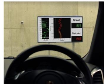
Fahrzeug positionierter Bildschirm verwendet. Um die Fahrversuche auf dem Prüfstand für den menschlichen Fahrer realistischer zu gestalten, soll ein neuer Versuchsaufbau entwickelt werden, welcher eine realistische Immersion erzeugen soll. Im Rahmen dieser Arbeit soll auf bestehenden Ergebnissen aus einem Workshop aufgebaut, ein zielführendes Konzept ausgewählt und konstruiert werden.
