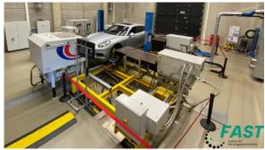
In aktuellen Forschungsprojekten werden dafür u.a. automatisierte Fahrfunktionen, als auch Gesamtfahrzeugprüfstände für reproduzierbare Testfahrten entwickelt und untersucht. Als Beispiel dafür dient der am Institutsteil Fahrzeugtechnik vorhandene Gesamtfahrzeugprüfstand ViL (Vehicle-in-the-Loop), welcher für die Untersuchung von Fahrzeugen in längs- und querdynamisch relevanten Fahrsituationen verwendet und Schritt für Schritt weiter entwickelt wird.
