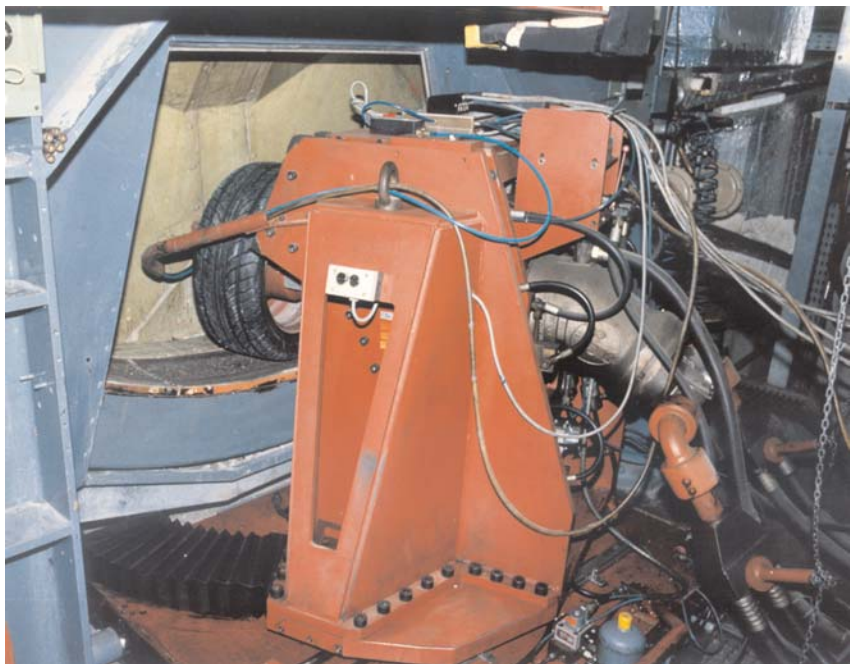
Bild 3: Die Prüfstands-Radaufhängung des Innentrommelprüfstands mit servohydraulischen Regeleinrichtungen Figure 3: The wheel suspension on the internal test drum test rig with servohydraulic control devices
