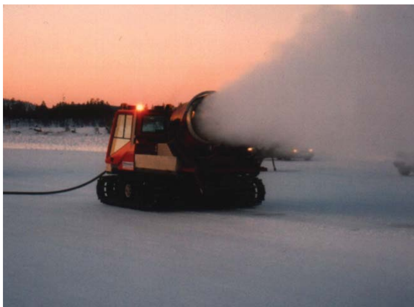
Bild 1: Niederdruckschneekanone im Betrieb Figure 1: Low-pressure snow gun in operation
