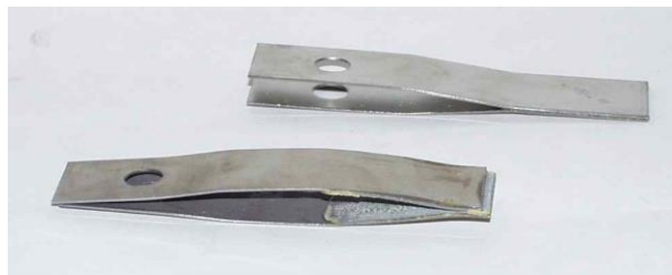
Impact Peel (ISO 11343) (AlMgSi 3,5 / BMW / 1,0 mm)
