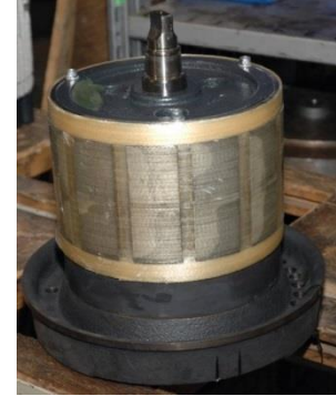
Permanenterregter Synchronmotor (Rotor)
