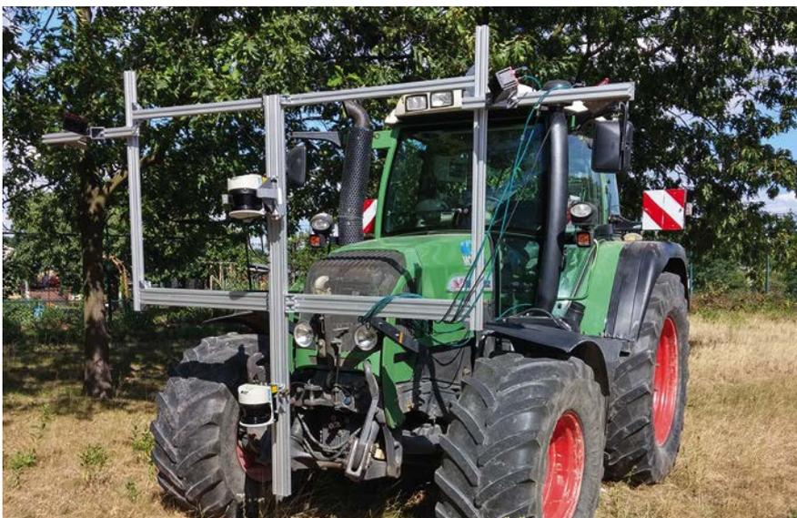
Bild 1: Prototypischer Aufbau zum Test der Umfeldsensorik des Slave-Traktors.
