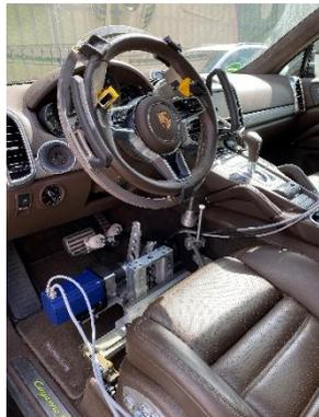
Um verschiedene menschliche Fahrerverhalten simulieren zu können, wird dafür eine Kombination aus Lenk- und Pedalroboter für Automatikfahrzeuge verwendet. Der aktuell verwendete Pedalroboter bietet Optimierungspotential in der mechanischen Kraftübertragung auf die Pedale sowie bei der eingesetzten Aktorik. Des Weiteren muss aktuell die Gangwahl sowie der Motorstart händisch vom Prüfstandsingenieur getätigt werden, sodass noch keine vollständige Automatisierung des Systems vorhanden ist.
